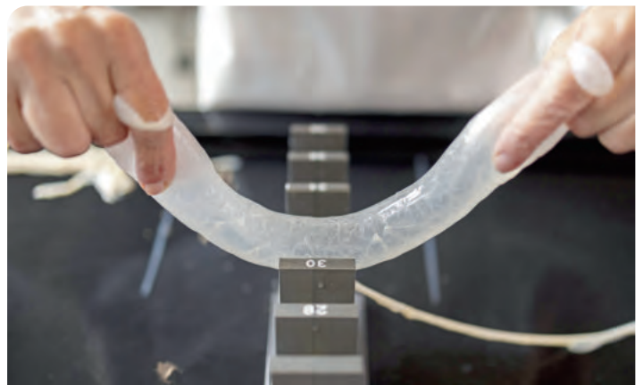
Zur Qualitätssicherung werden Naturdärme unter Druck mit Wasser oder Luft gefüllt, so lassen sich mögliche Beschädigungen erkennen. Foto: Zentralverband Naturdarm / rotshot.de
